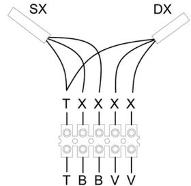
FIGURE 8— POSITION DES CÂBLES SUR LE BORNIER
