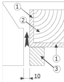
FIGURE 8 - ISOLATION POUTRE
