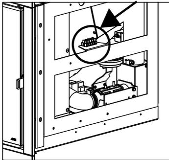
FIGURE 7— POSITION DU BORNIER
