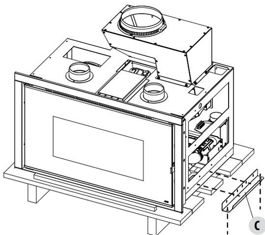
Positionner le poêle et raccorder le conduit de fumée.
