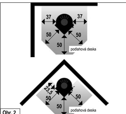
Rozměry jsou uvedeny v cm
