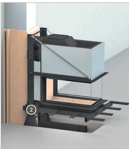
Si le cadre de montage ne peut pas être fixé statiquement au plafond ou à la paroi arrière, le cadre de support BRUNNER (2) est installé. Vissé à la plaque de base, il est utilisé comme support autonome et résistant pour l'insert de cheminée et le cadre de montage.
