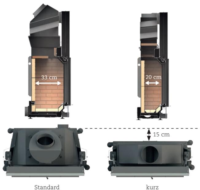
La combinaison de la construction réduite avec le manteau de convection permet une profondeur d'installation de moins de 60 cm (voir page 32). L'évacuation de chaleur permet de réduire au minimum les épaisseurs d'isolation et les distances par rapport aux murs.
