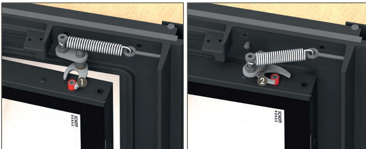
Pendant le processus de fermeture, le manchon de verrouillage (rouge) est saisi / encerclé par le bras de verrouillage (1). Si le point de basculement est dépassé pendant le processus de fermeture, le „doigt de traction“ (2) saisit et tire la porte vers le corps via le ressort précontraint.
