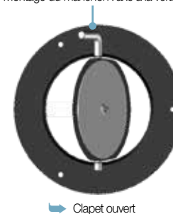
Montage du manchon : axe à la verticale
