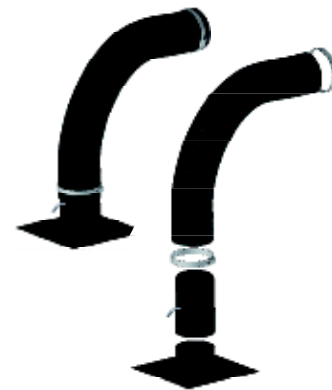
Montage du manchon : axe à l'horizontal
