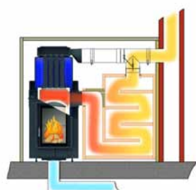
Fonctionnement accumulateur avec clapet Moritz (trappe basculante)
