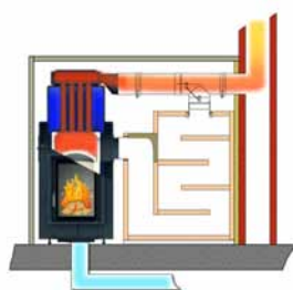
Fonctionnement chaudière avec clapet Moritz
