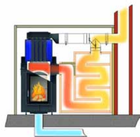
Fonctionnement accumulateur avec clapet Moritz (trappe basculante)
