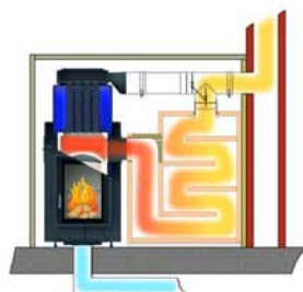
Fonctionnement accumu- lateur avec clapet Mo- ritz (trappe basculante)
