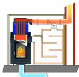
Fonctionnement chaudière avec clapet Moritz
