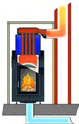
Fonctionnement chaudière avec connection directe
