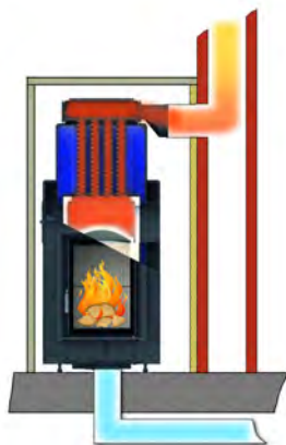
Fonctionnement chaudière avec connection directe
