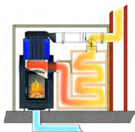
Fonctionnement accumulateur avec clappet Moritz (trappe basculante)
