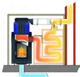
Fonctionnement accumulateur avec clapet Moritz (trappe basculante)
