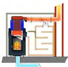
Fonctionnement chaudière avec clapet Moritz
