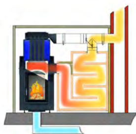
Fonctionnement accumulateur avec clapet Moritz (trappe basculante)
