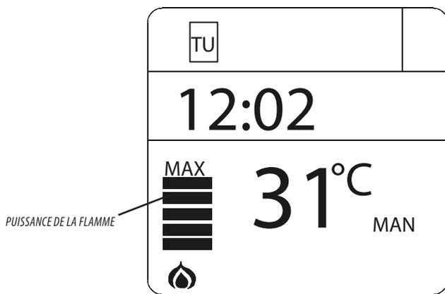
En cas de configuration MANUELLE de la ventilation, la fonction qui limite la puissance maximale du poêle en fonction de la ventilation, est activée.
