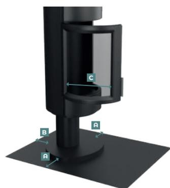
Le dimensionnement de la plaque de sol doit délimiter des distances de sécurité minimum (Sur les côtés "A", à l'arrière de l'appareil "B", et sur la face avant "C", dite zone de chargement), en fonction de la taille de l'appareil de chauffage au bois. Ces distances de sécurité sont mentionnées dans la notice de pose du fabricant du poêle.
