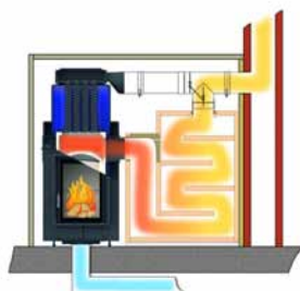
Fonctionnement accumulateur avec clapet Moritz (trappe basculante)
