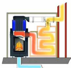
Fonctionnement accumulateur avec clapet Moritz (trappe basculante)
