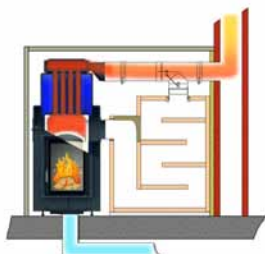
Fonctionnement chaudière avec clapet Moritz
