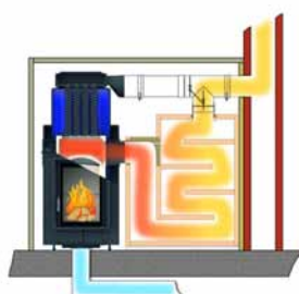
Fonctionnement accumuleur avec clapet Moritz (trappe basculante)
