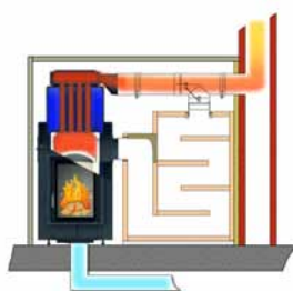
Fonctionnement chaudière avec clapet Moritz
